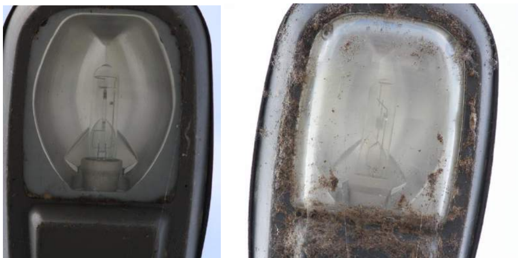
Figura 25 – Immagini di lampade ai vapori di sodio ad alta pressione (sinistra) e ai ioduri metallici (destra)
